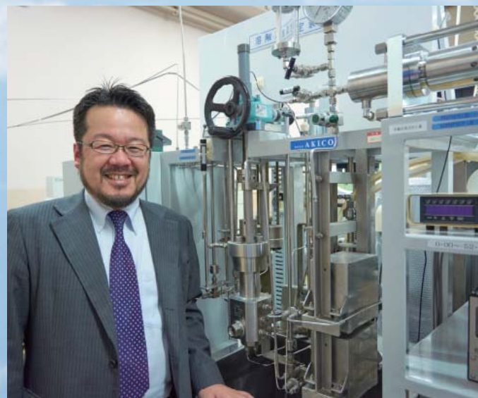
イオン液体に二酸化炭素がどれくらい溶けたかを測定する「イオン液体・二酸化炭素吸収実験装置」（児玉准教授の右側）は、世界に一台しかない日大工学部オリジナルの実験装置
