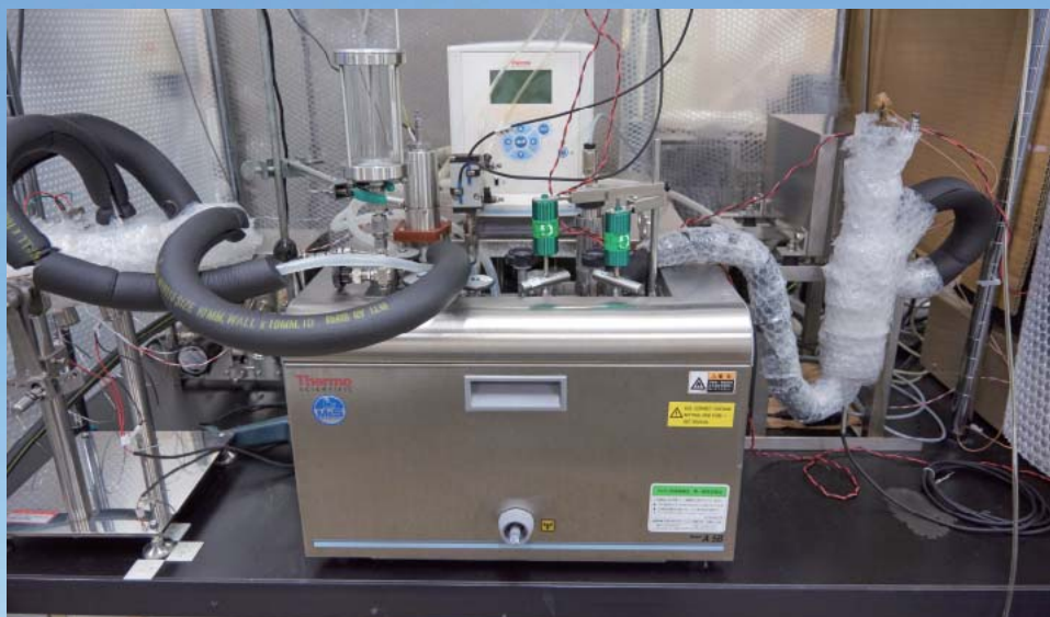
イオン液体物性測定装置。イオン液体の粘度、密度、溶解度を一度に計測できる装置で、導入は2013年。従来の装置よりもコンパクトに改良され、15 mLほどの試料で実験ができるようになった
